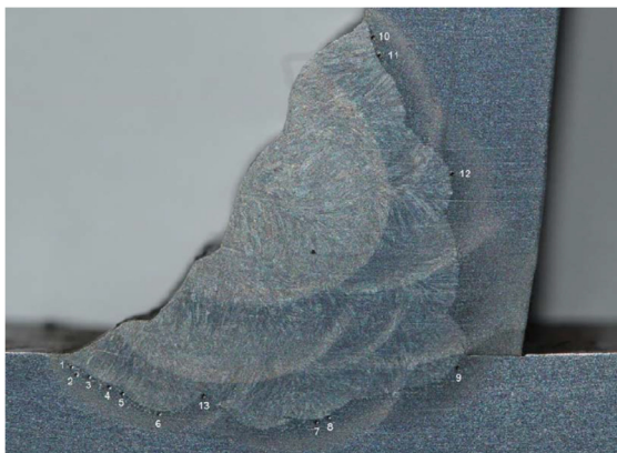
Obr. 3 – Kontrola tvrdosti materiálu
