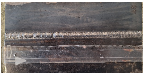
Obr. 6 – Kontrolovaný tupý zvar - povrch
